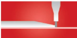
Die Facette ist eine schräg geschliffene Kante zur genaueren Strichführung.
