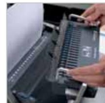
Die herausnehmbare Plattform **SATELLITE** ermöglicht gleichzeitiges Stanzen und Binden durch zwei Benutzer und erhöht die Produktivität.
